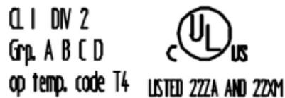
Abb. 4.1.2-4: Bedruckungstext Detail gemäß CENELEC and IEC
